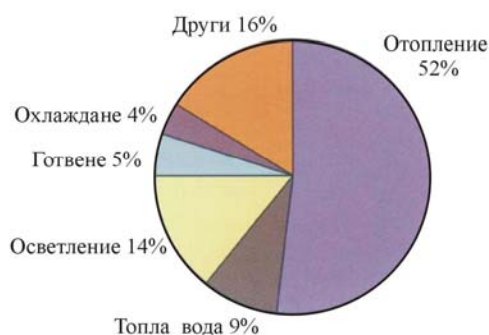
Фиг. 4.2 : Графика на крайното потребление на енергия всгради за търговия в ЕС
