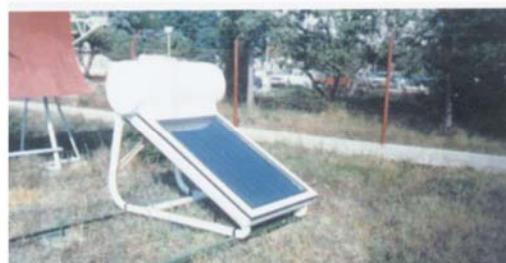
Слънчев водонагревател с топлинни тръби и акумулатор
